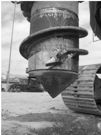
Abb. 4 Bohrspitze aus UHPC (Italien 2010)
