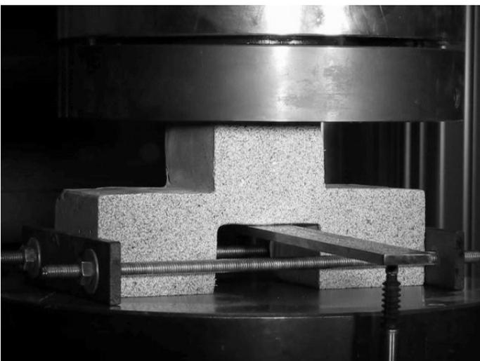
Abb. 3: Schubfestigkeitsprüfung eines Prüfkörpers aus UHPC
