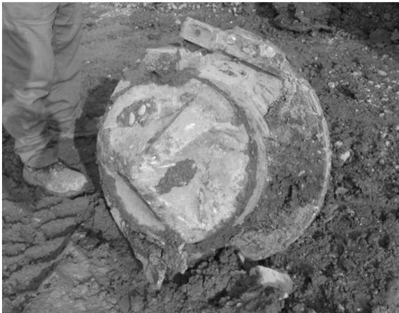
Abb. 5: Bohrspitze aus UHPC nach Bohrvorgang
