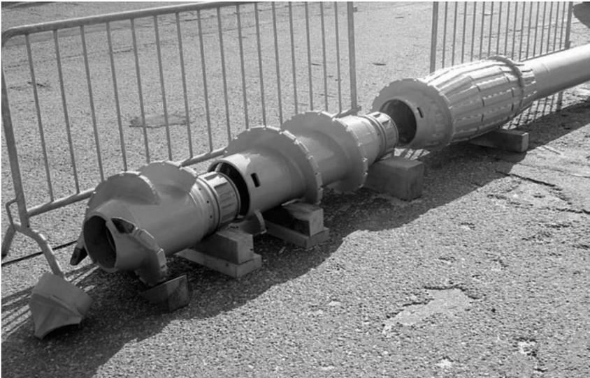
Abb. 2: Klassische Stahlbohrspitze (links) mit horizontal liegendem hohlem Bohrgestänge (rechts)
