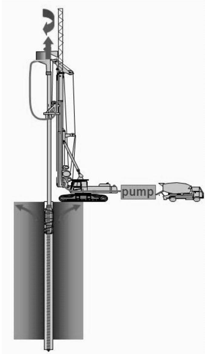
Abb. 1: Verdrängerpfahltechnik im „Lost-Bit-Verfahren“
