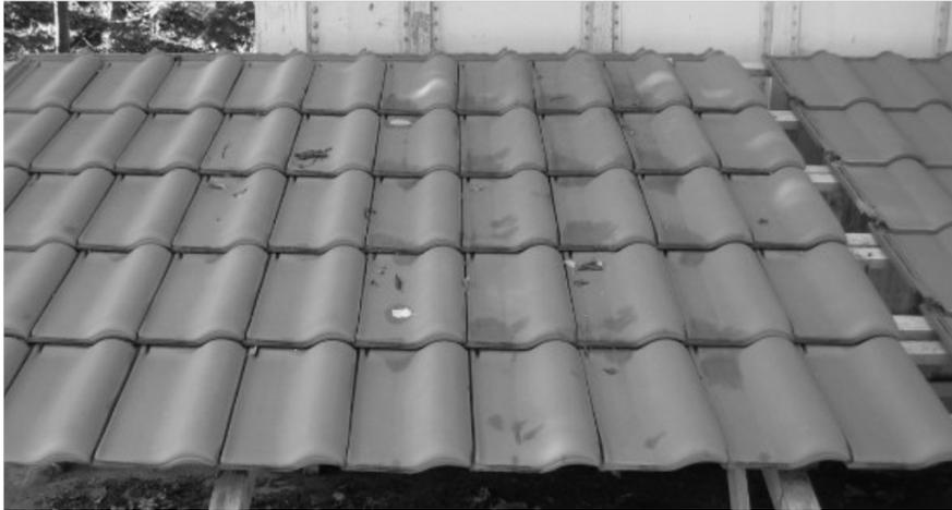
Bild 3: Tondachziegel von Erlus auf einem Bewitterungsstand mit transparenter  $\text{TiO}_2$  Schicht (links) und Biofilm (rechts).
