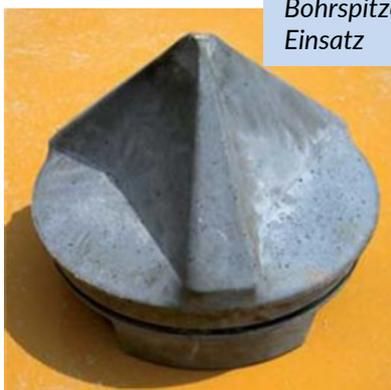
Bohrspitzen aus UHPC im praktischen Einsatz
