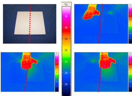
Foto des Demonstrators der hälftig mit (rechte Seite) und ohne (linke Seite) low-e Fassadenfarbe bestrichen ist. Die Bilder der Thermokamera visualisieren das unterschiedliche Abstrahlverhalten der IR-Aktiven Oberfläche (rechte Seite des Demonstrators) beim darüber halten einer Hand
