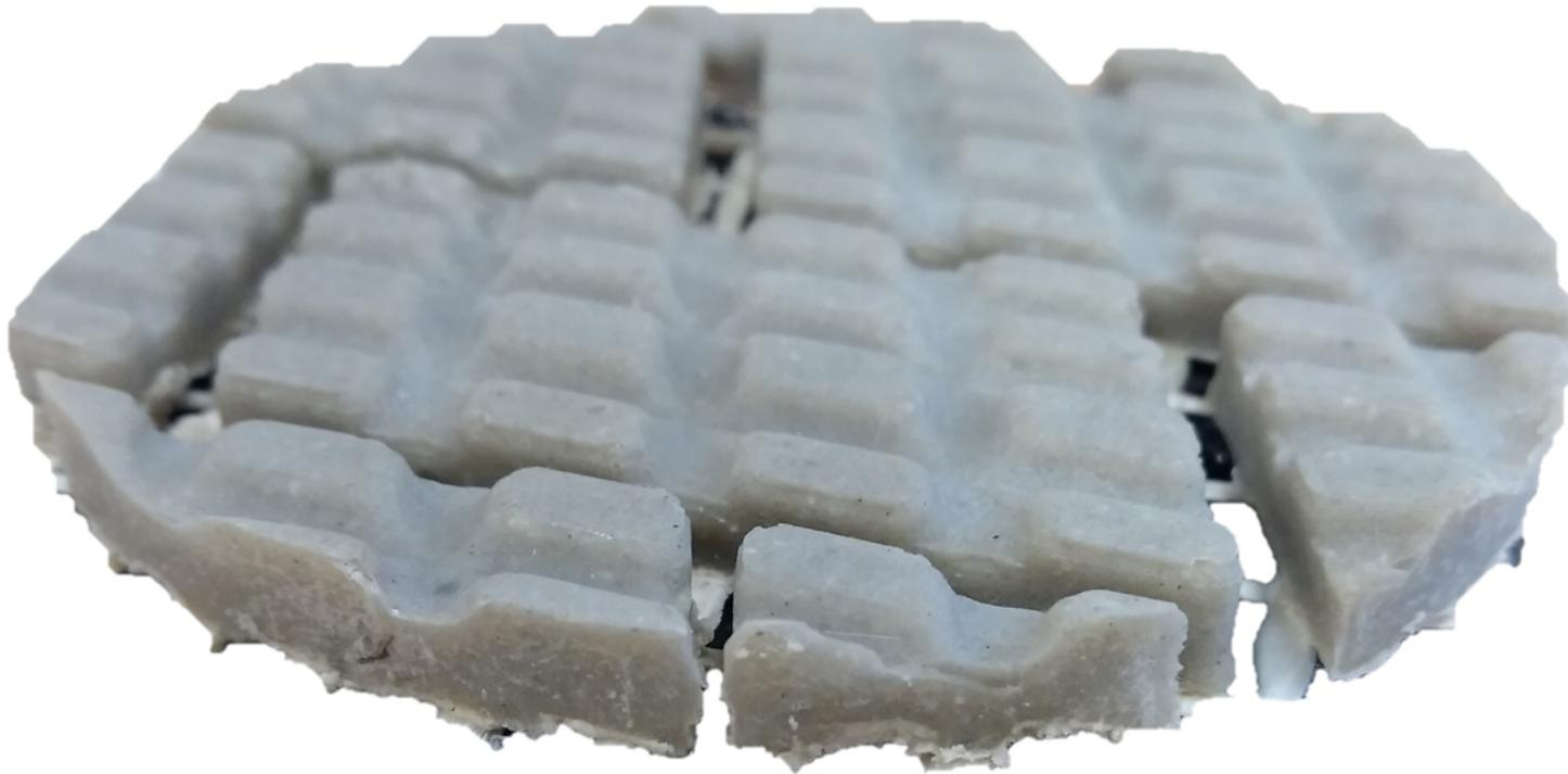
Detailansicht der INNO-PAVE Strukturschicht ( $\varnothing = 100 \text{ mm}$ )
