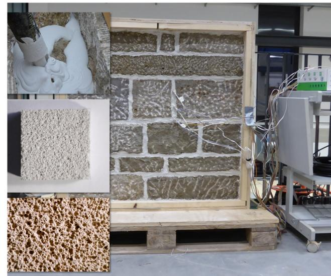
Bild 2: Demonstrator Natursteinmauerwerk mit Feuchtesensoren zur Simulation des Austrocknungsverhaltens nach Verfüllung mit Schaummörtel
