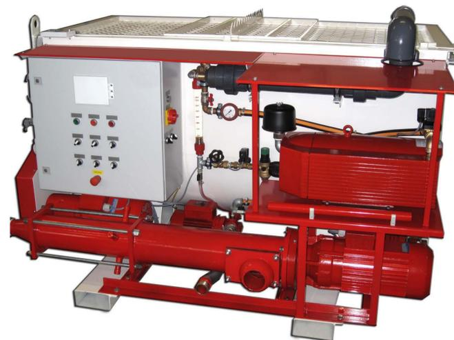
Bild 3: Anlage zur Herstellung vom Schaumgipsmörtel im Chargenbetrieb unter Baustellenbedingungen
