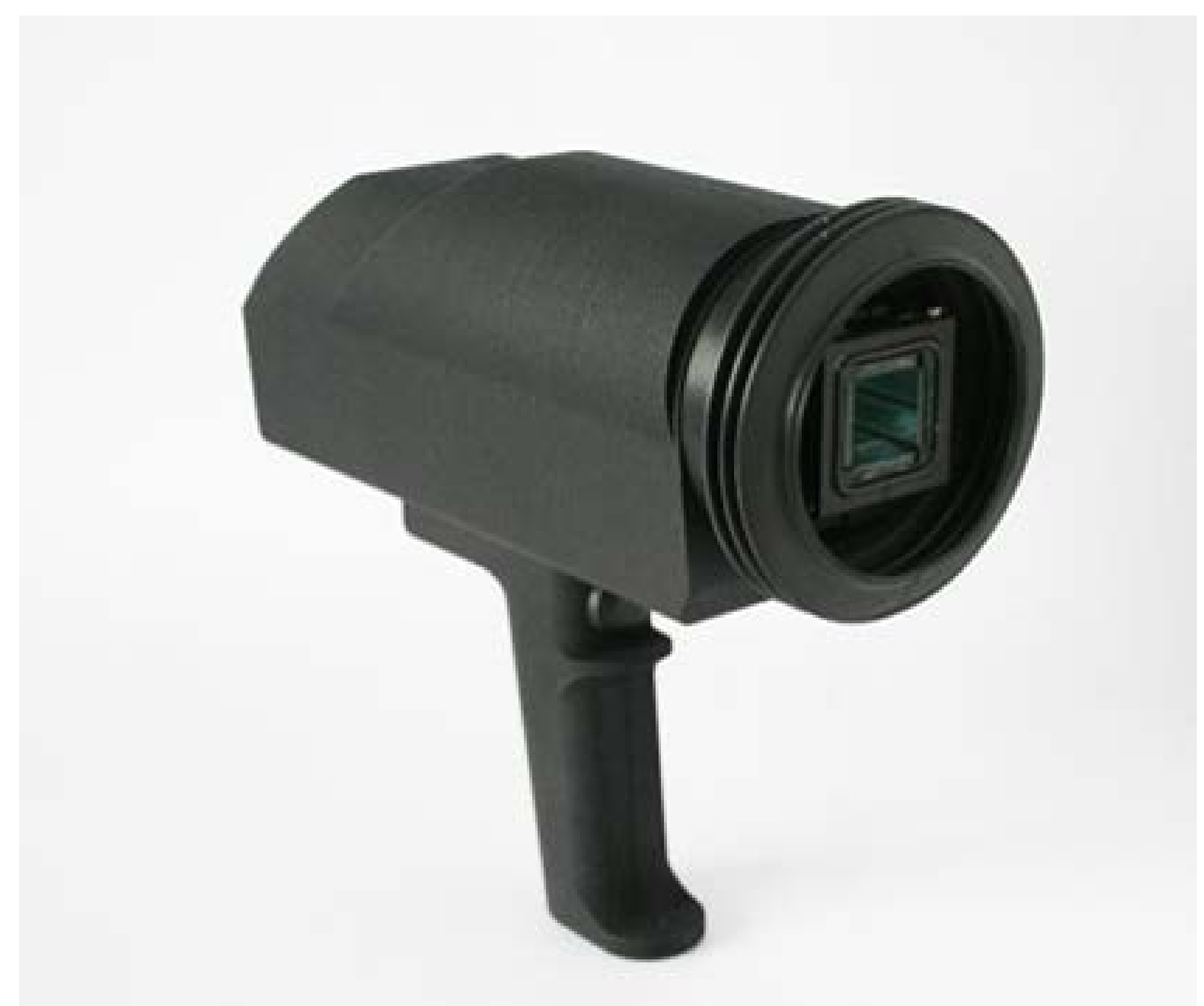
Entwickelter Demonstrator für ein mobiles GPS-gestütztes Messgerät zur Charakterisierung photokatalytischer Aktivitäten von Baustoffoberflächen
