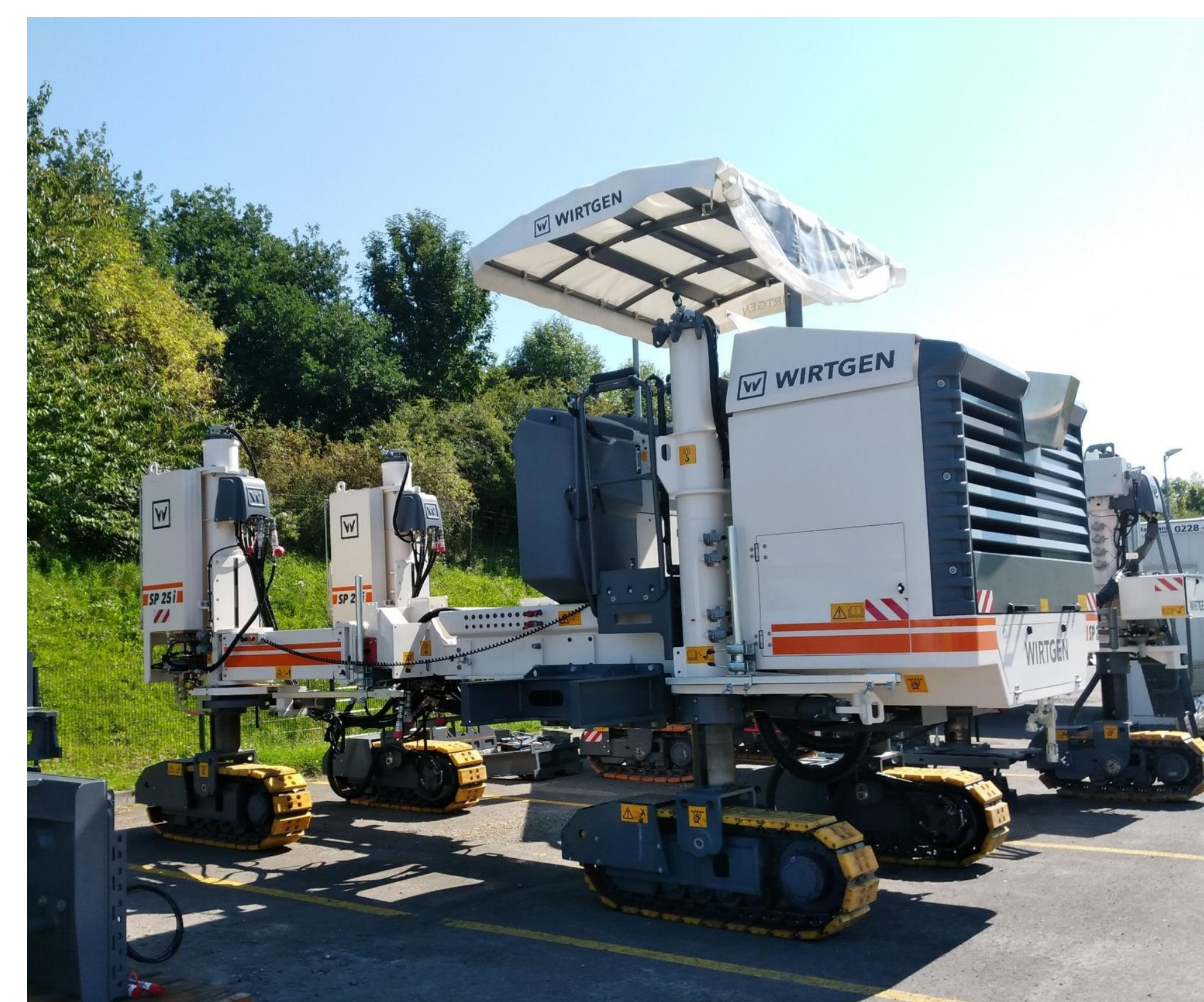
Bild 3: PU-Fertiger für den Einbau der Absorptionsschicht
