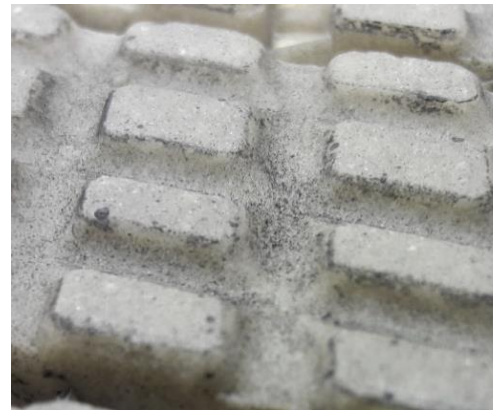
Bild 2: Geprüfte INNO-PAVE Strukturschicht (nach Belastung durch Aachener Ravelling Tester (ARTE))
