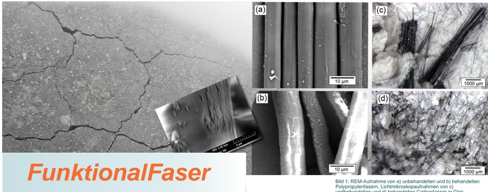
Bild 1: REM-Aufnahme von a) unbehandelten und b) behandelten Polypropylenfasern. Lichtmikroskopaufnahmen von c) unbehandelten und d) behandelten Carbonfasern in Gips
